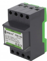
Skyddstransformator 230 VAC, 24 VAC 16 VA, DIN-fäste
