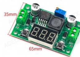
DC-DC BUCK 3A adjustable buck module, + Voltmeter
