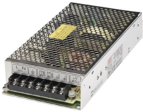
Nätaggregat Mean Well S-60-5 5Volt 60W 1 utgång
