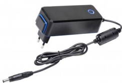
Nättaggregat, Väggadapter, EU, Mascot 3721, 15VDC, 2.8A, 42W, 5.5x2.1
