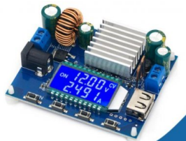
DC/DC-omvandlare Step Down 5..30V till 0,6...23V 30W
