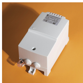
Transformator Tufvassons PVS120, 120 VA 220/12V 10A
