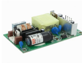
Nättaggregat Mean Well NFM-20-15 15 Volt 20W
